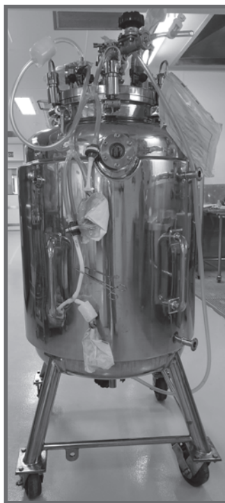
Figura 6 – Tanque de aço inoxidável com eletropolimento com as características necessárias para o processamento da vacina Covid-19
