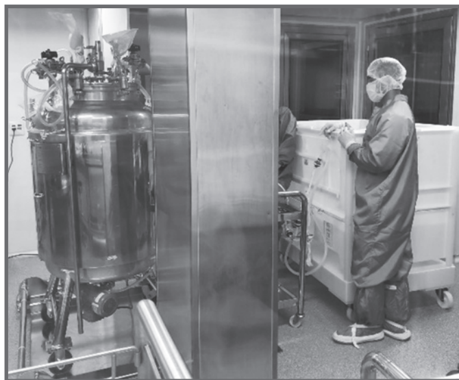
Figura 9 – Processo de transferência da solução-tampão para o tanque de formulação
